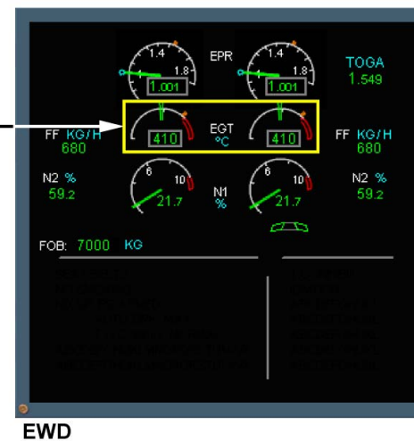
PRIMARY PARAMETERS - LPT SECTION PARAMETERS DESCRIPTION
