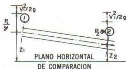
Figura 194. Energía total del líquido en dos secciones a lo largo de la conducción.
