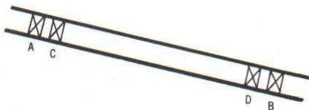
Figura 202. Instalación adecuada de válvulas.
