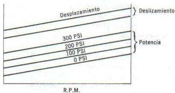
Figura 147. Rendimiento de bomba rotatoria con viscosidad constante.
