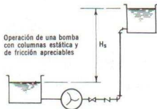
Figura 171. Operación de una bomba con cargas estática y fricción apreciables.
