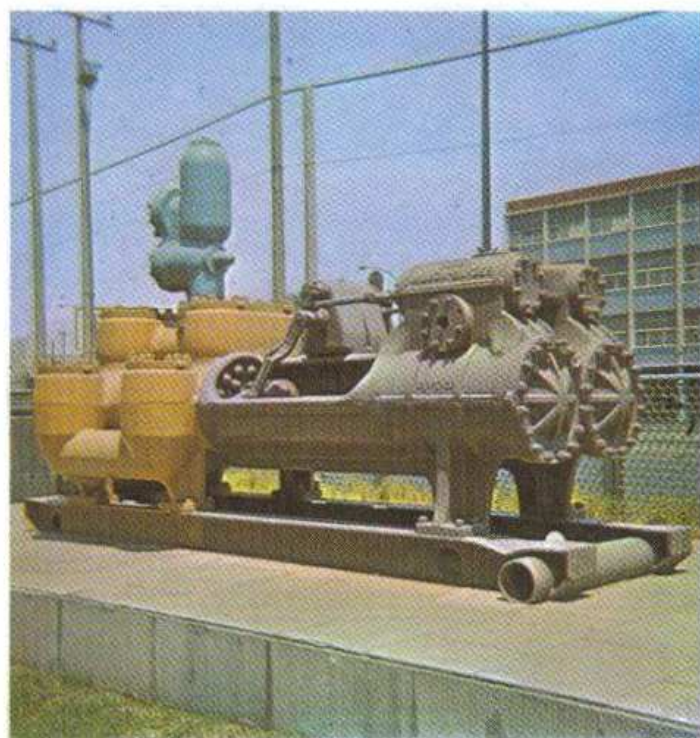
Figura 221. Bomba de lodos de 2 cilindros accionada por gas. Marca Super Wilson Snyder 16 1/4-7 1/4-20. (Cortesía Oficina Pemex-México.)
