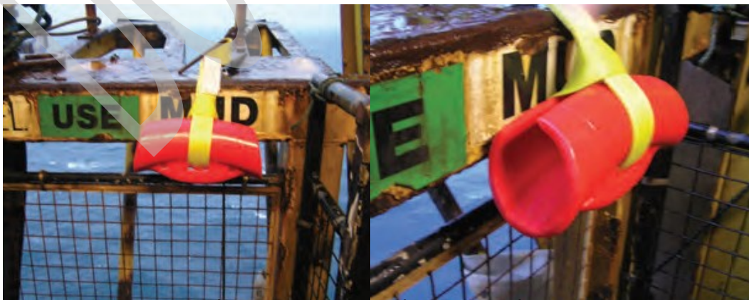
Gambar 73. Secure slang yang benar
