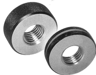
Figura 6.56B. Calibre pasa y no pasa para roscas exteriores.
